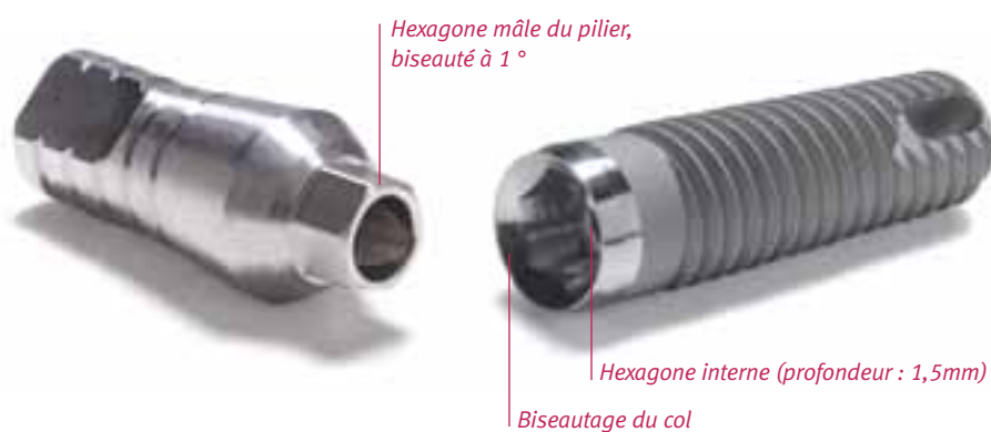
Figure 1 Les piliers pour implants Tapered Screw-Vent ® et autres implants Zimmer à hexagone interne sont dotés d'un hexagone mâle de forme légèrement biseauté (1° de la base du pilier à la plate-forme de l'hexagone). Lorsque le pilier est placé dans l'implant sous l'effet du couple appliqué, l'hexagone du pilier engage par friction les parois de l'hexagone interne de l'implant. Cette friction élimine pratiquement tout effet de rotation entre ces deux éléments.
